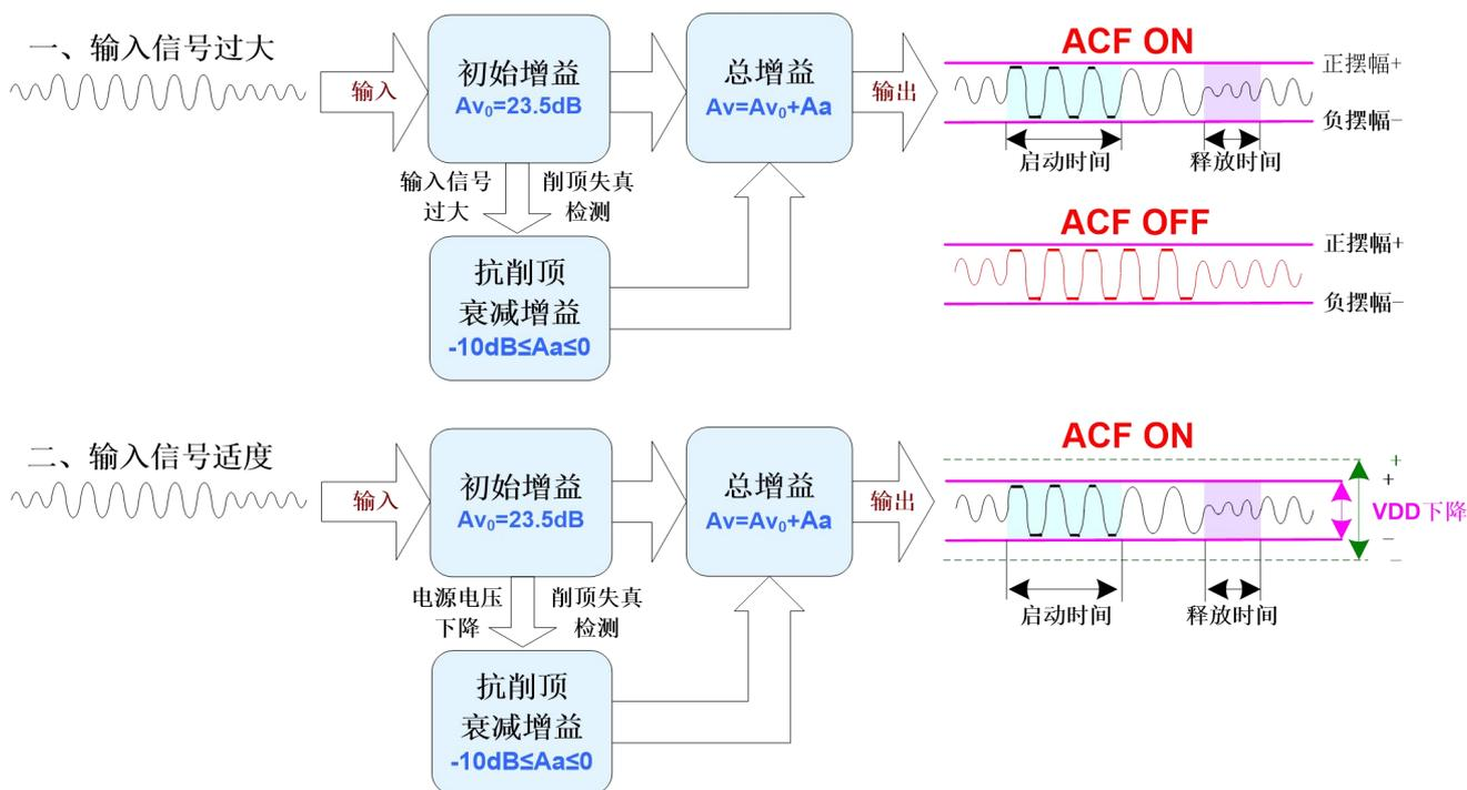
图 5 ACF 工作原理示意图
